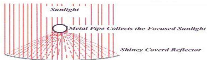
شکل ۱- بازتاب نور خورشید بر روی لوله گیرنده انرژی
