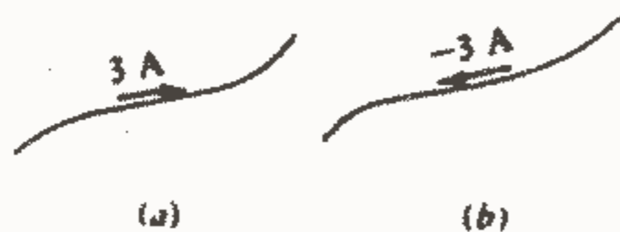
شکل ۵-۱: دو روش برای نشان دادن یک جریان واحد.
