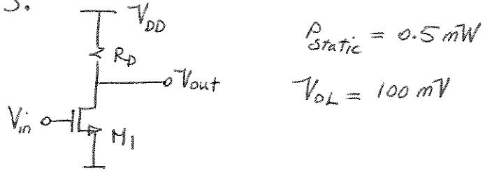
$$\frac{(V_{DD} - V_{OL})^2}{R_D} + V_{OL} \times \frac{V_{DD} - V_{OL}}{R_D} = 0.5 \times 10^{-3}$$
