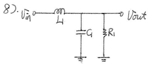
$$a). \quad V_{out} = V_{in} \cdot \frac{R_1 // C_1 s}{R_1 // C_1 s + SL_1}$$
