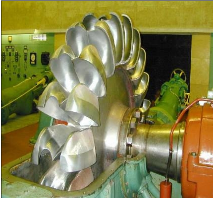
شکل ۴-۱: نمونه ای از توربین چرخ پلتون
