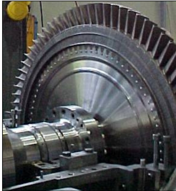
شکل ۳-۴: نمونه هایی از یک توربین گاز جریان محوری یک طبقه
