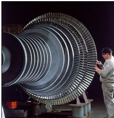
شکل ۴-۲: نمونه ای از یک توربین بخار چند محوره
