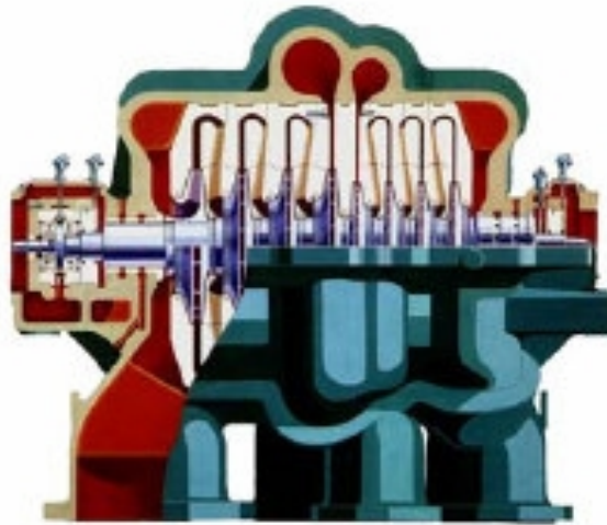
شکل ۵-۵: شماتیک یک کمپرسور با خنک کن میانی
