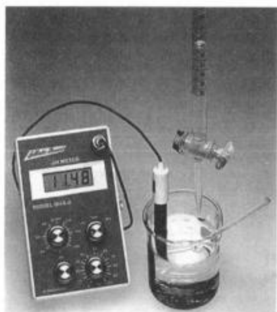
شکل (۲۵) - استفاده از \text{pH} سنج دیجیتال برای سنجش حجمی
