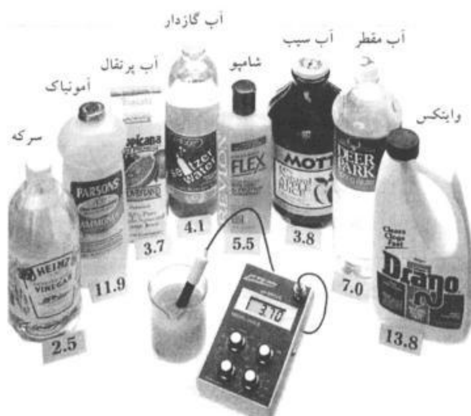
شکل (۲۰) - تعیین pH چند محلول متداول به کمک pH سنجهای دیجیتالی
