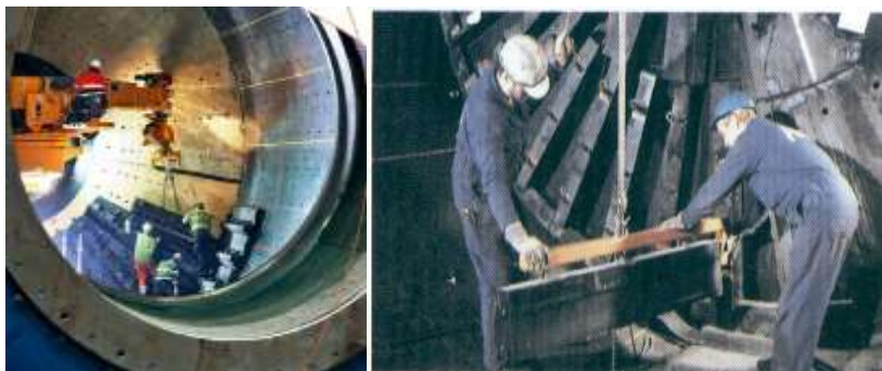
شکل ۱۱-۱۸- نحوه تعویض آسترهای لاستیکی
