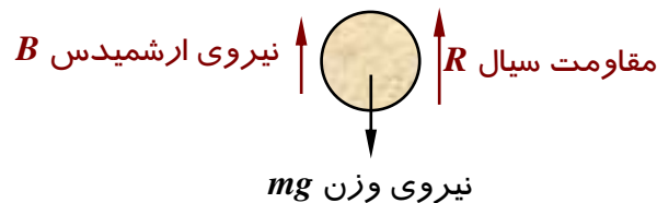
شکل ۸-۱- نیروهای وارده بر یک جسم در حال سقوط درون سیال
