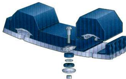
شکل ۱۱-۱۵- نحوه اتصال آستر لاستیکی
