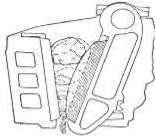
شکل ۳-۵- مقایسه فک مسطح و انحناءدار
