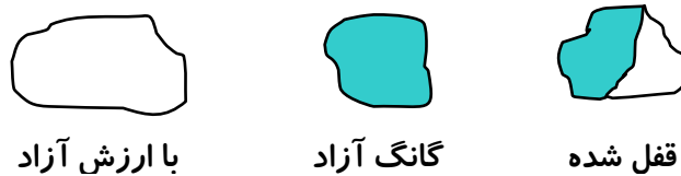
شکل ۱۰-۱- انواع ذرات از نظر میزان آزاد شدگی
