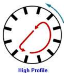
شکل ۱۱-۳- تأثیر ارتفاع بالابر بر مسیر حرکت
