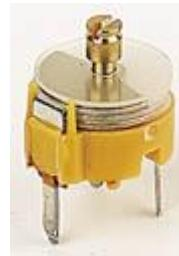
خازن های تریمیر خازن های تریمیر خازن های متغیر کوچک و با ظرفیت بسیار پائین هستند . ظرفیت این خازن ها از حدود ۱ تا ۱۰۰ پیکوفاراد ماست و بیشتر در تیونرهای مدارات با فرکانس بالا مورد استفاده قرار می گیرند خازنها بخاطر خصوصیات خاصی که دارند در مدارات الکترونیکی از آنها زیاد استفاده میکنند.
