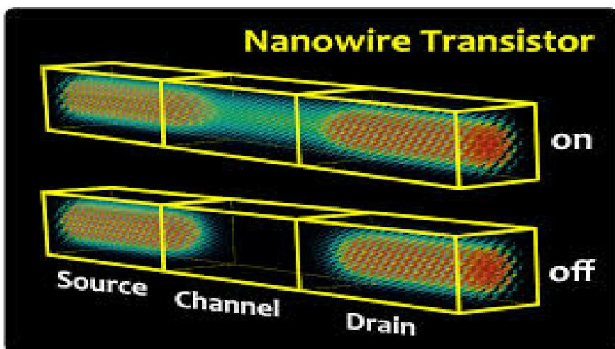
عبارة ترانزیستور از ترکیب دو واژه انتقال و مقاومت به وجود می‌آید. در یک نانو ترانزیستور گرافنی FET مقاومت بین دو الکترود میتواند توسط یک الکترود سوم منتقل و یا کنترل شود. اتصال سورس و اتصال درین از طریق یک نیمه هادی صورت (نانو یه گرافنی) میگیرد. نانو الکترود گیت از نیمه هادی به وسیله عایق‌بندی الکتریکی یه دی الکتریک گیت جدا میشود. بنابراین، نانو الکترود گیت به صورت یه گرافنی به نیمه هادی متصل میشود و پتانسیل الکترواستاتیک رابط نیمه هادی/عایق را کنترل میکند.
